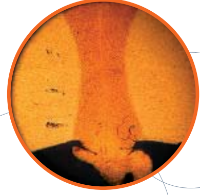
İç çapaklı normalize olmamış boru
